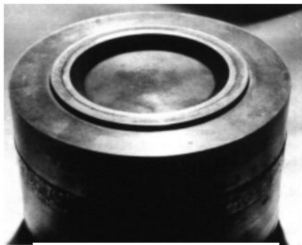
Superficie del asiento del disco deformada por chattering
