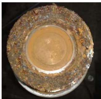
Ataque de cloruro en disco de acero inoxidable 18Cr-8Ni
