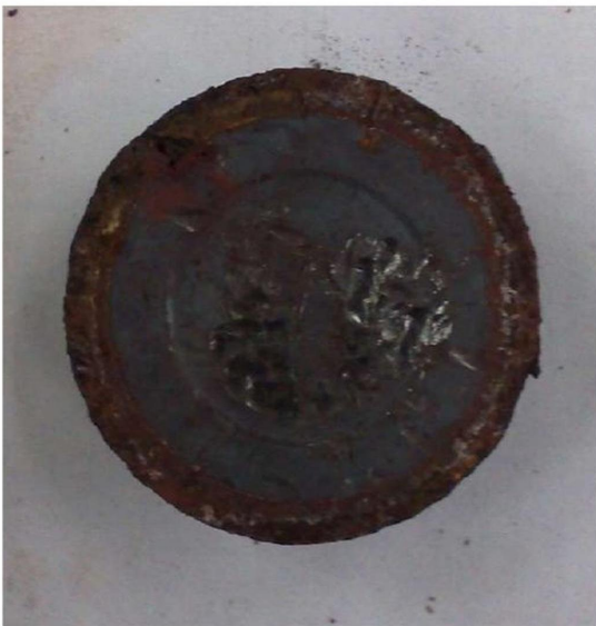
Corrosión ácida en bonete, disco oxidado, corrosión por atmósfera inapropiada y corrosión ácida en tobera
