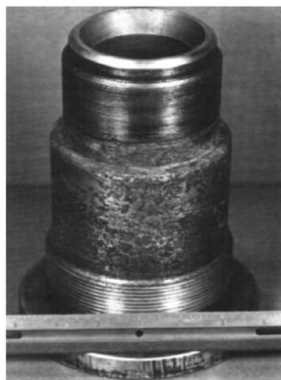
Corrosión de cloruro en la tobera de acero inoxidable 18Cr-8Ni (con la superficie de asiento maquinada)
