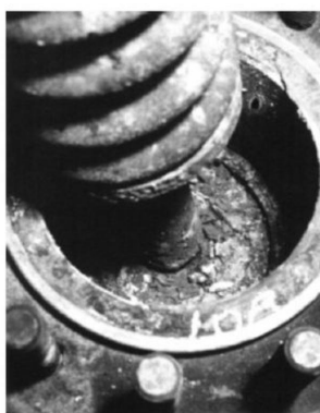
Piezas móviles de la válvula sucias con sulfuro de hierro ( \text{FeS}_2 )
