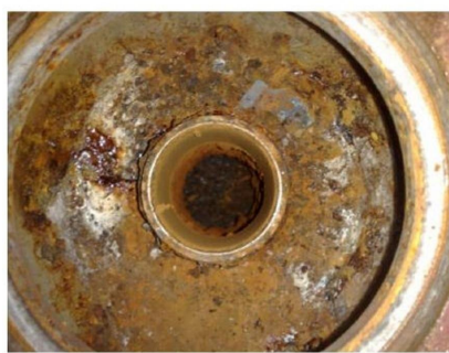
Disco y partes móviles dañadas por depósitos de óxido ferroso Corrosión por cloruros y sulfuros en toberas, discos y fuelles
