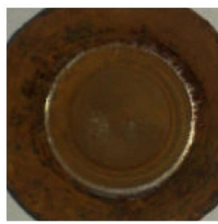
Tipo de corrosión en fuelle de acero inoxidable 18Cr-8Ni (tipo 316)
