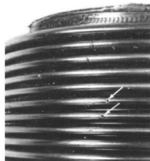
Tipo de corrosión en fuelle de acero inoxidable 18Cr-8Ni (tipo 316)
