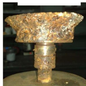
La válvula se pegó por los depósitos del sulfuro de hierro ( \text{FeS}_2 )
