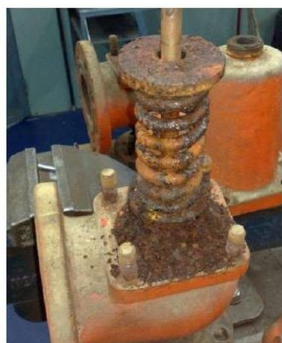
Salida de la válvula tapada con los depósitos de otras válvulas con colector de descarga
