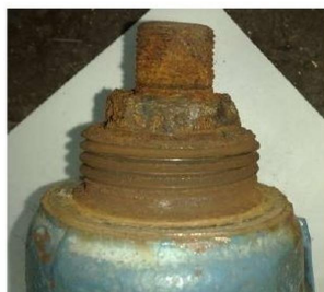
Piezas móviles de la válvula sucias con sulfuro de hierro ( \text{FeS}_2 )
