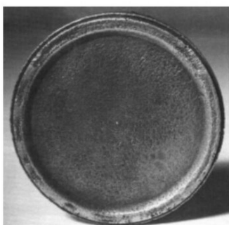
Ataque de cloruro en disco de acero inoxidable 18Cr-8Ni
